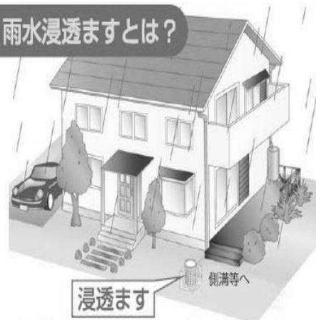
雨水を地中にしみ込ませ、都市型水害の発生を抑制すると同時に、水資源の有効利用や地下水の確保につながる施設です。
